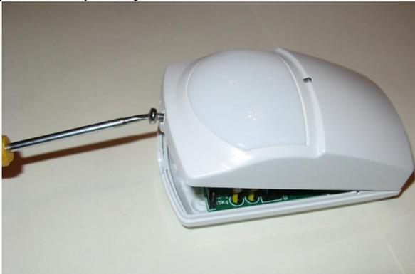
Датчик имеет клеммы для подключения питания (+12В, -12В), охранный релейный выход, и тамперный выход (детектор вскрытия датчика). На "+12" и "-12" подается питание от ППК. На один из контактов реле, так же подается минус. Второй контакт реле подключается к охранной зоне 2. Аналогично, при необходимости, подключается тамперная зона.
